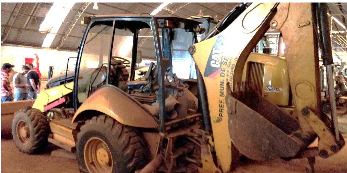
O equipamento está em bom estado de conservação, pneus em bom estado, caçamba, sistema hidráulico em bom estado, folgas nos embuchamentos, motor em regular estado bomba injetora necessita reparo. Não está rodando. O valor comercial regional do referido veículo é de R\$ 46.750,00 (Quarenta e seis mil setecentos e cinquenta reais).
